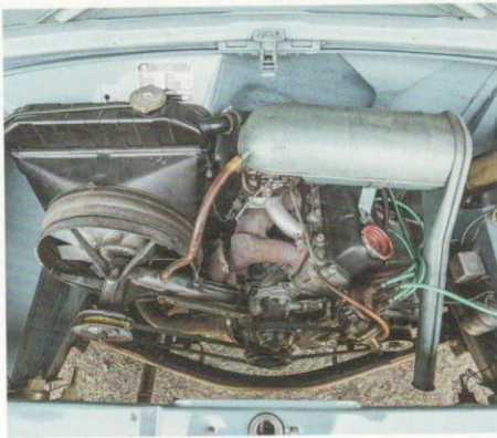
I TAKTO MŮŽE VYPADAT motorový prostor. Ač velkou část zabírá mohutná sahara s ventilátorem, stále zbyvá dostatek místa. K motoru je doslova luxusní přístup.
