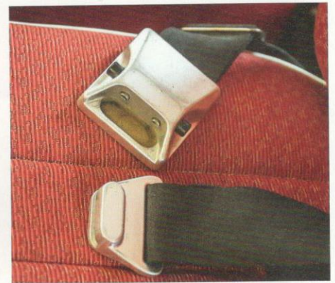
BEZPEČNOSTNÍ PÁSY byly tehdy u nás novinkou, stovka byla první škodovkou, která je měla od počátku vždy ve výbavě. Samozřejmě nebyly samonavíjecí.
