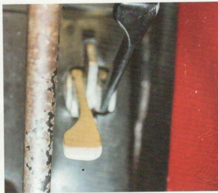
ČERNÁ PÁČKA MEZI SEDADLY ovládá vzduchovou přívěru, která byla novinkou roku 1970, svítíla topení. Stovky kvůli dlouhému vedení k radiátoru špatně topily.
